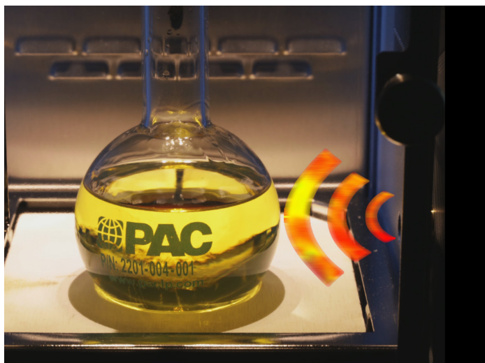
Ciągły zdalny pomiar temperatury cieczy czujnikiem podczerwieni
